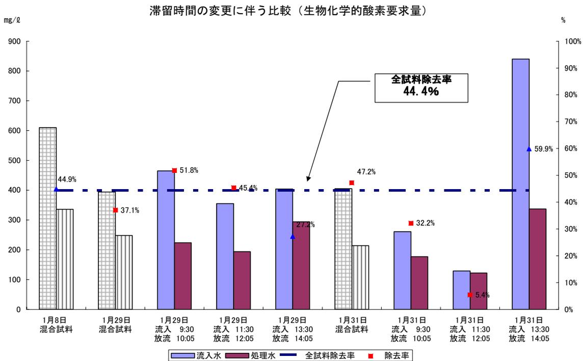
図5-24 滞留時間に関する調査結果（生物化学的酸素要求量）
