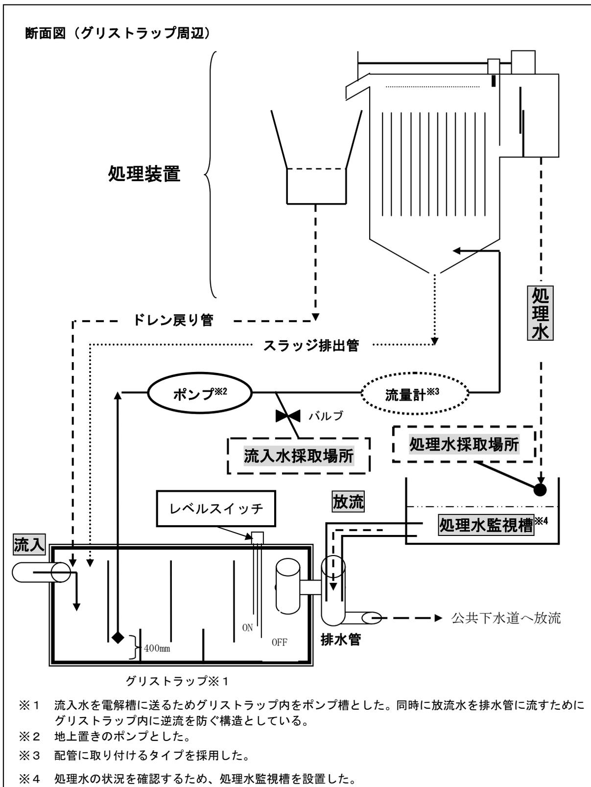
図3-2 実証対象機器の配置図 (断面図)
