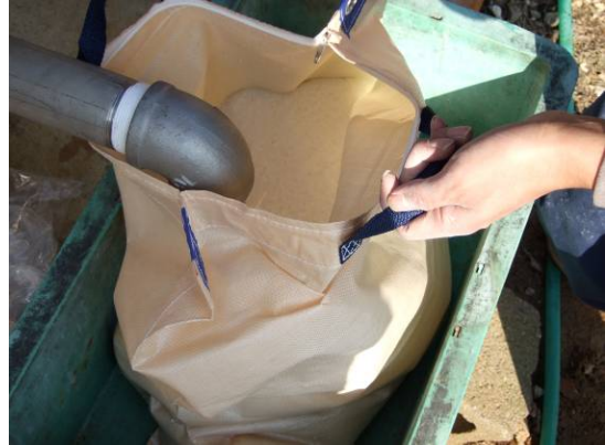
ろ過袋への汚泥抜き出し作業
