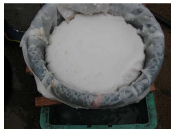
重力脱水後の汚泥
