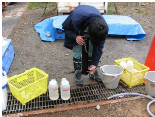
処理水の透視度確認
