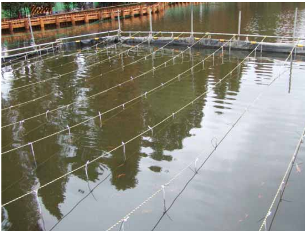
写真4 実証試験区における炭素繊維房の設置状況
