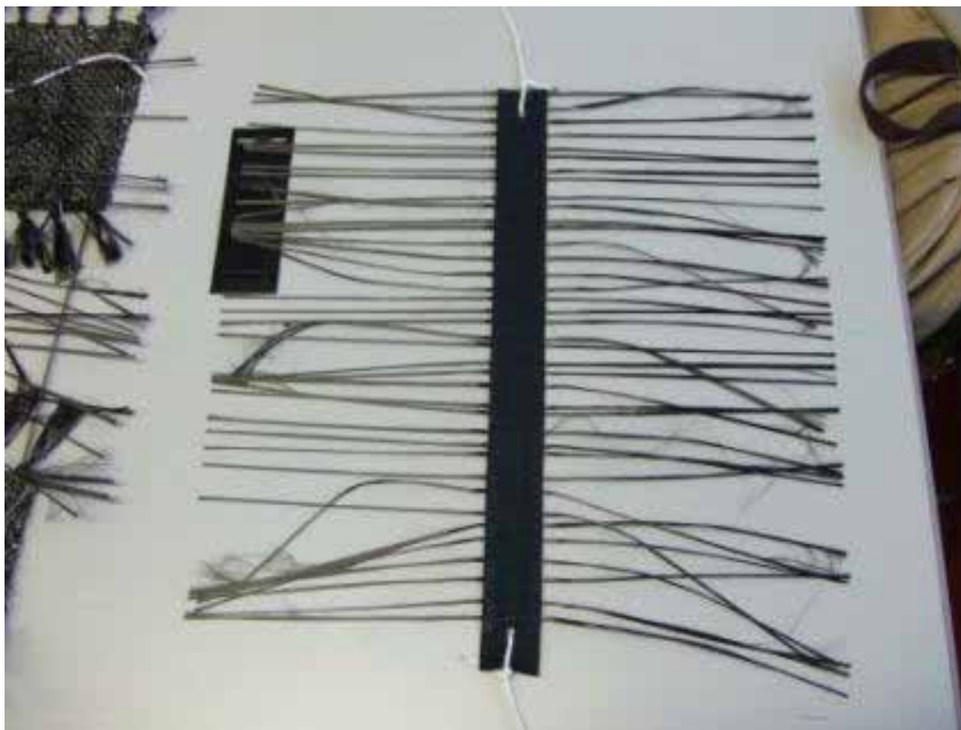
写真 3 代表的な炭素繊維房の形態 ( 組紐状ストランド成形体 )
