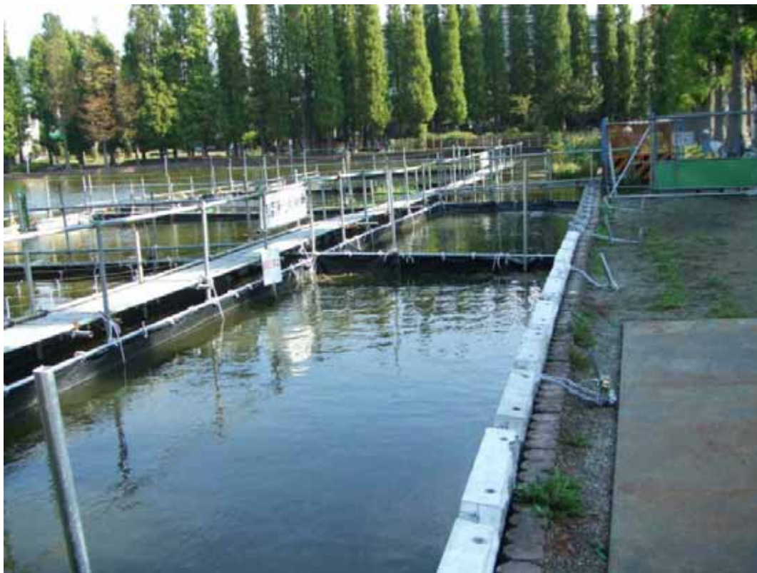
写真3 浄化ブロック設置状況 (手前：対照区、奥：処理区)
