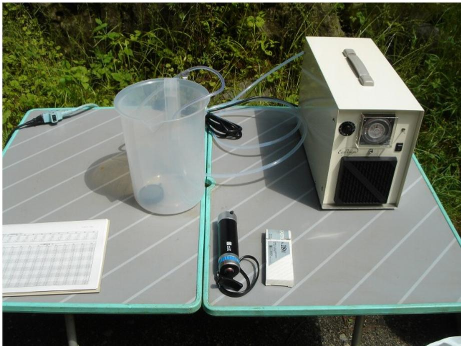
図 オゾン発生装置と容器および検知管
