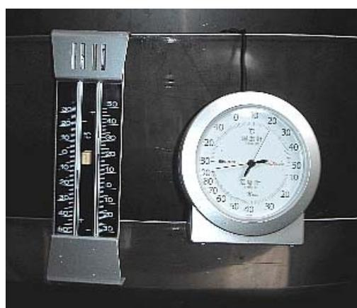
図5-3 屋内の最高・最低温度計と湿度計
