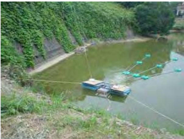
図4 - 2 水位低下時 (8/30) の機器の状況 (写真) (左: 1号機、右: 2号機) (機器後部が池底に着底して傾き、吐出角度が下向きとなっている)
