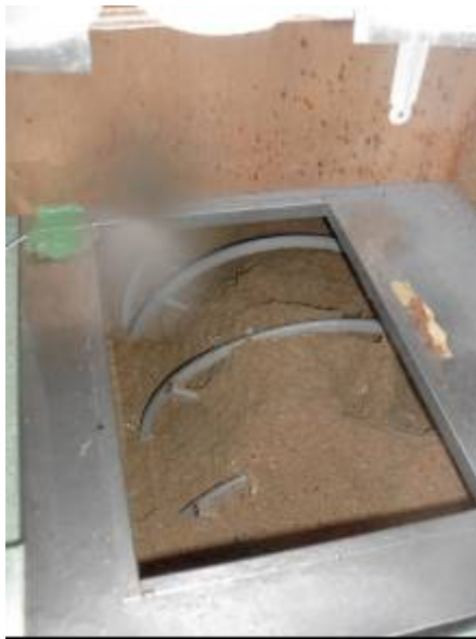
オガクズ攪拌槽内部
