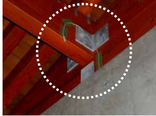
温湿度センサーの拡大写真
