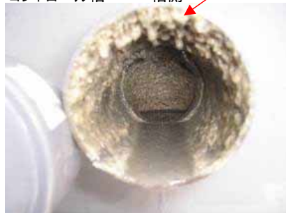
図5 - 15 配管詰まりの状況写真
