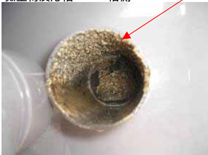
図5 - 15 配管詰まりの状況写真
