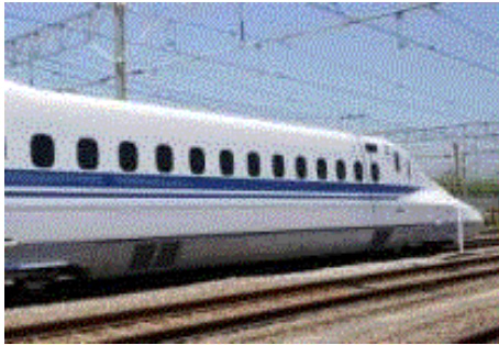
ポリカーボネート樹脂製窓
