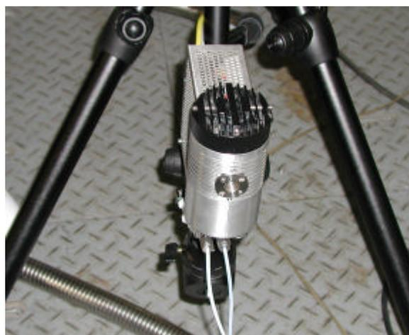
図4 高速CO/CO2計のセンサ部
