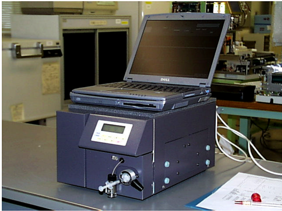
写真1 ポータブル型イオンクロマトグラフを用いたオンサイト型水質モニターの外観
