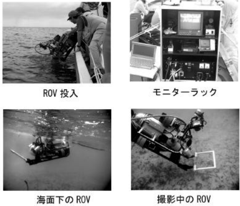
図1 運用中の改良型水中走行ビデオシステム
