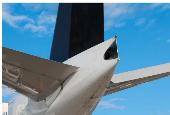
図 4.1-6 APU（補助動力装置）の排気口
