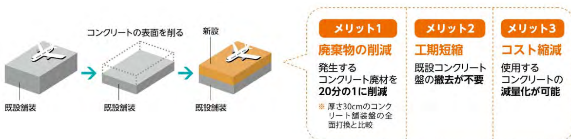
図 4.2-8 完全付着型オーバーレイ工法
