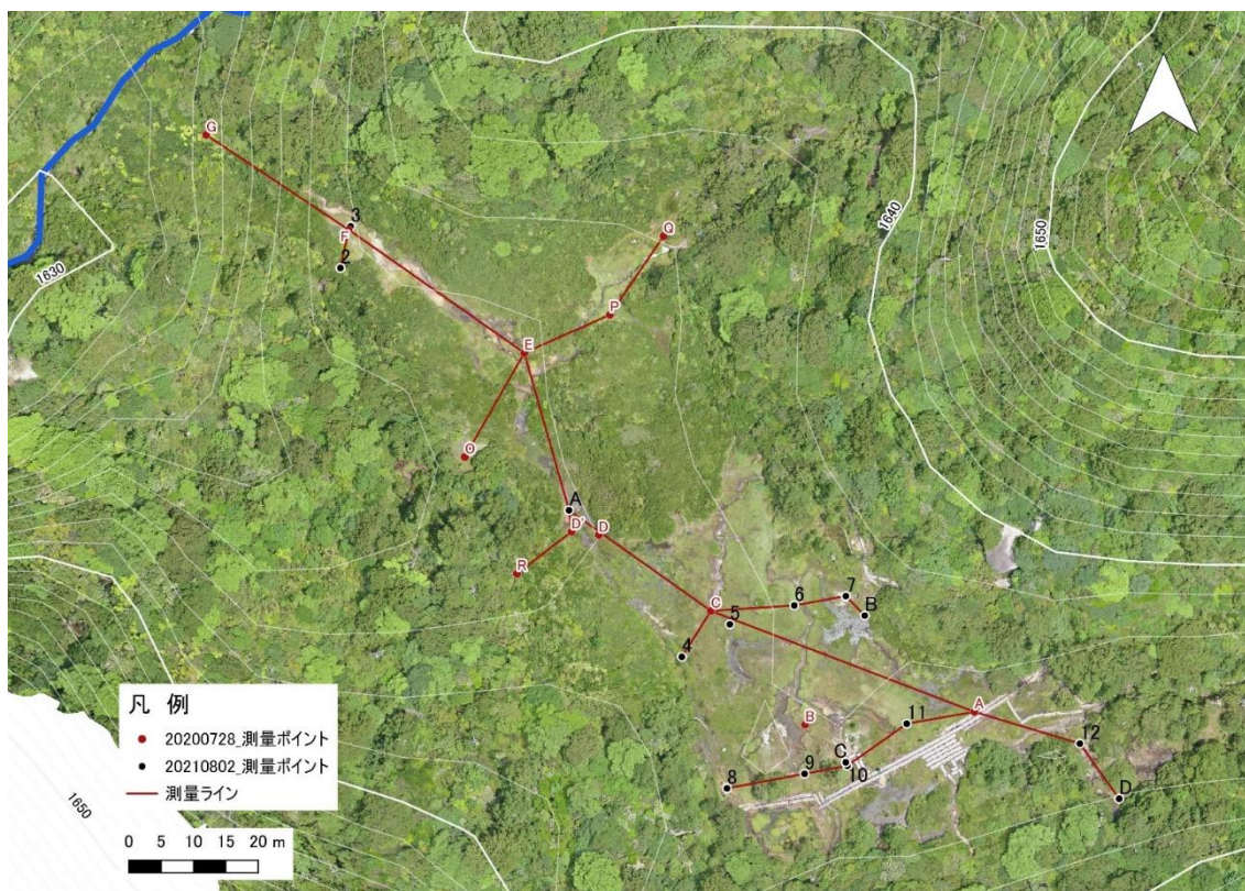
図3 縦断・横断方向のトラバース測量、基盤地質の調査地点
