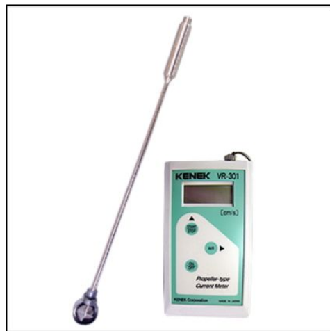
写真2 プロペラ式流速計
