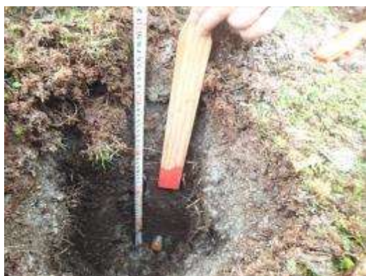
泥炭溫度、ミズゴケ直下観測の様子（左：泥炭、右：ミズゴケ直下）
