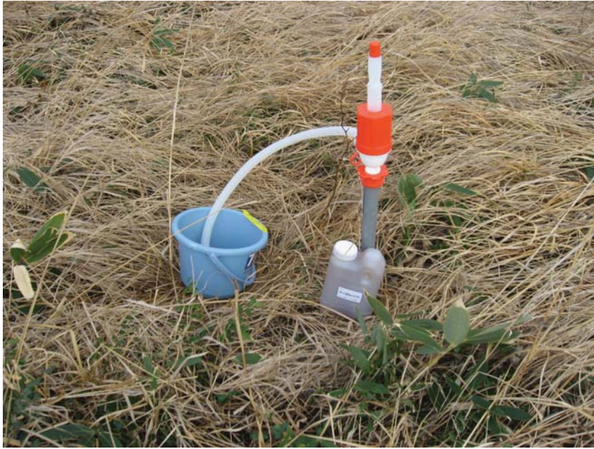
図 3-2 西側湿原部観測孔の採水状況
