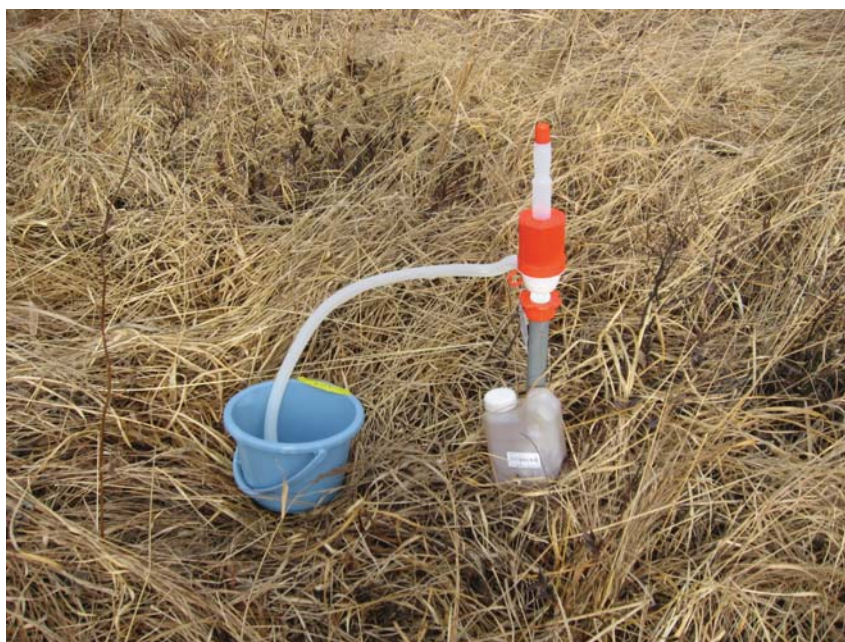
図 3-1 東側湿原部観測孔の採水状況
