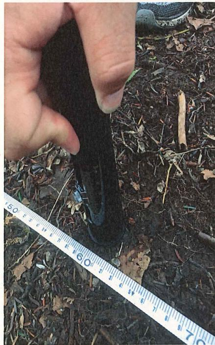
土壌硬度計を使った硬度測定
