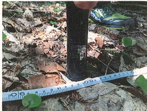
土壌硬度計を使った硬度測定
