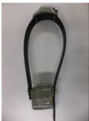
写真 2-1-2-1 GPS 首輪 (GPS Plus)
