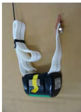
写真 2-1-2-2 VHF 電波発信器 (LT-01)
