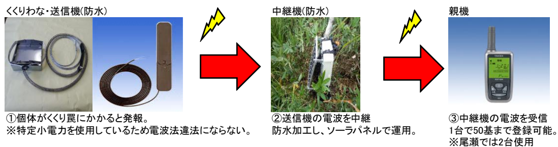
図 3-3 簡易自動通報システム
