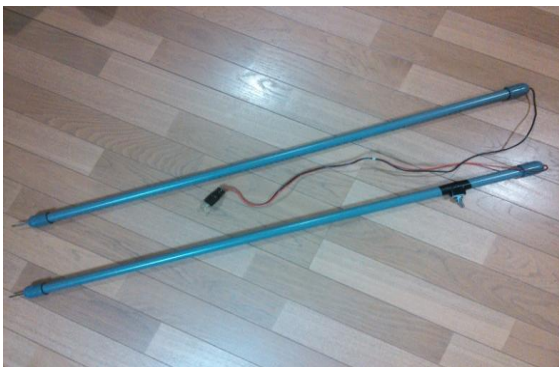
写真3-9 電極棒 (安全対策として、片方の電極棒にスイッチを取り付けてある)
