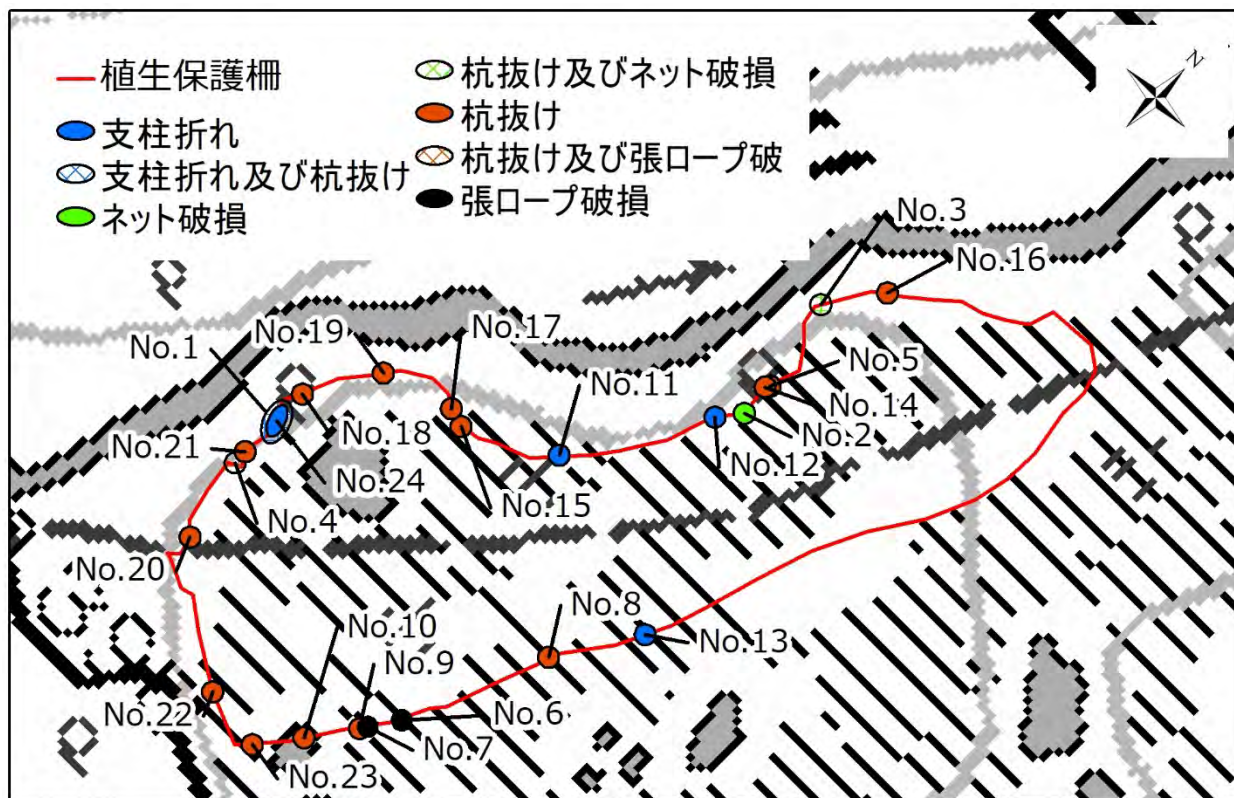
図 4.2-4 植生保護柵破損箇所
