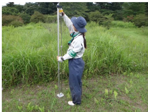
(長谷川式土壌貫入計を設置)
