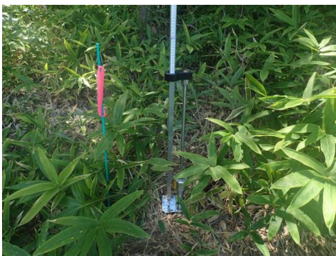
（長谷川式土壌貫入計を設置）
