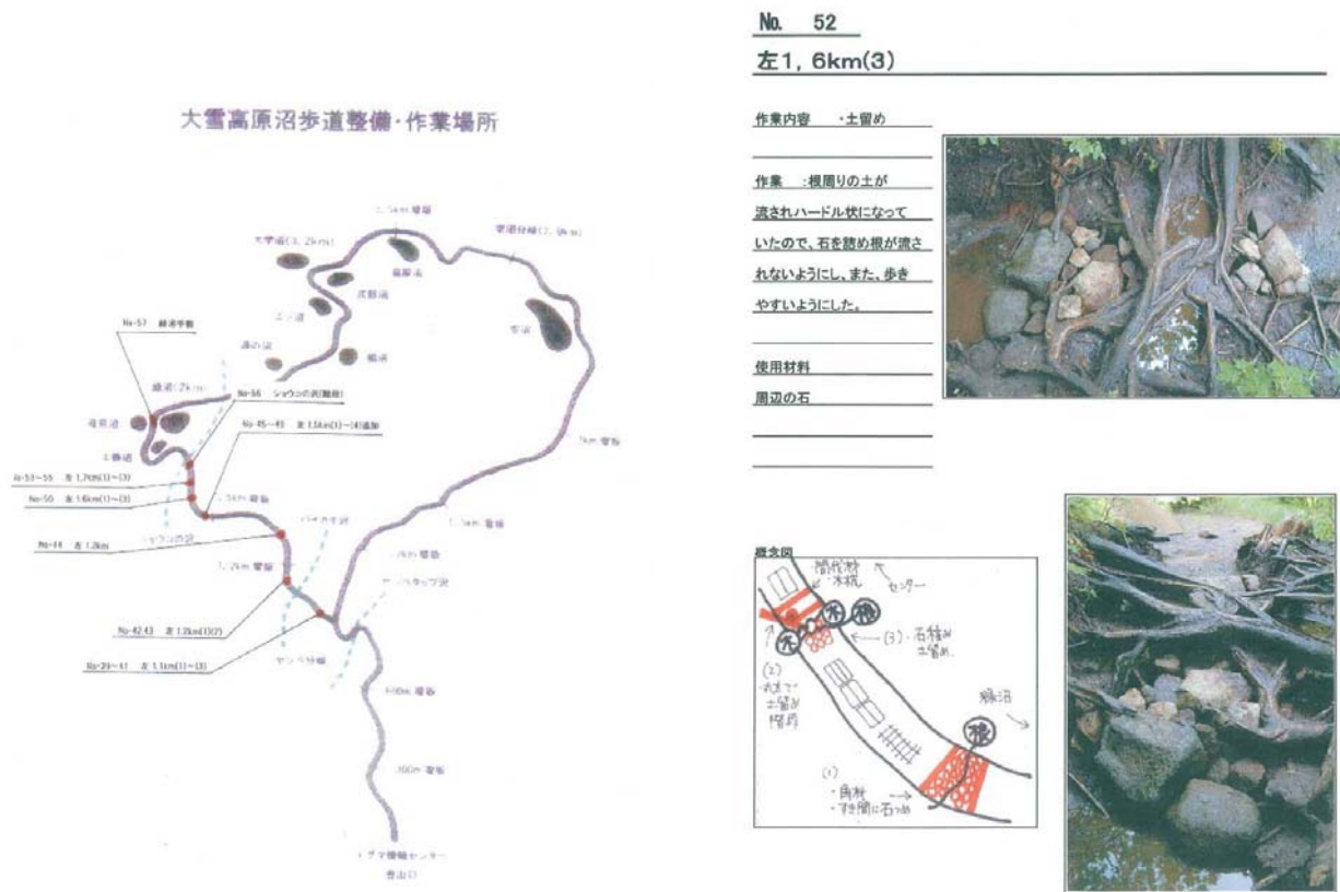
図 14 カルテ参考例：「ヒグマ情報センター」による大雪高原沼歩道整備の記録（佐藤委員提供） 位置、作業内容（概念図）、修復の理由、目標（ねらい）、使用材料、作業前後写真を記録
