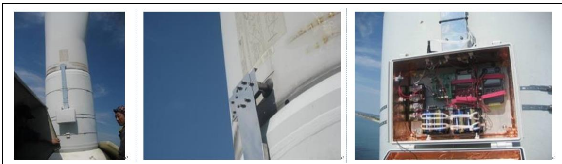
図 3-1- 29 振動センサ、サーフェスマイクロホンの設置状況
