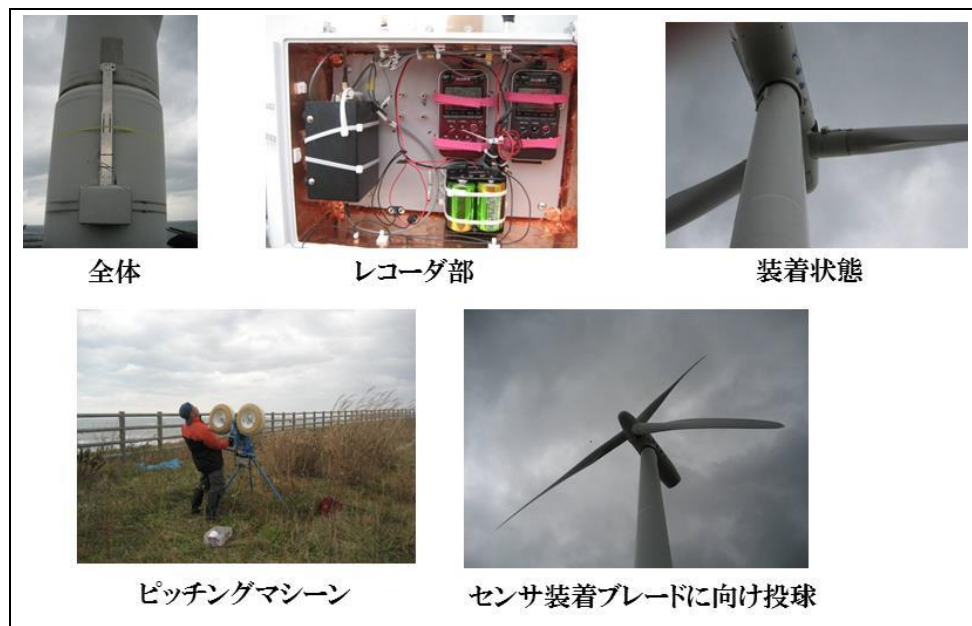
図 3-1- 31 ソフトボールによる衝突実験状況
