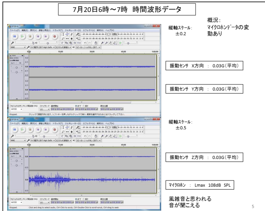
図 3-1- 30 風車への装着実験で得られた波形データ
