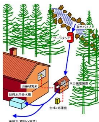
図 6-7. 日本山岳会 山岳研究所における水力利用実験施設の模式図 3)
