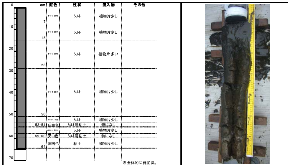
図16 湖中央部(水深1.7m)における柱状採泥結果(2010年7月22日) 9)
