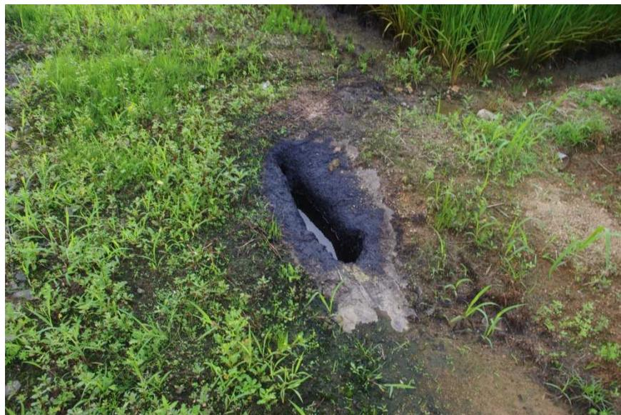
図 1 廃坑井戸から地表に漏れ出した原油を含む地下水
