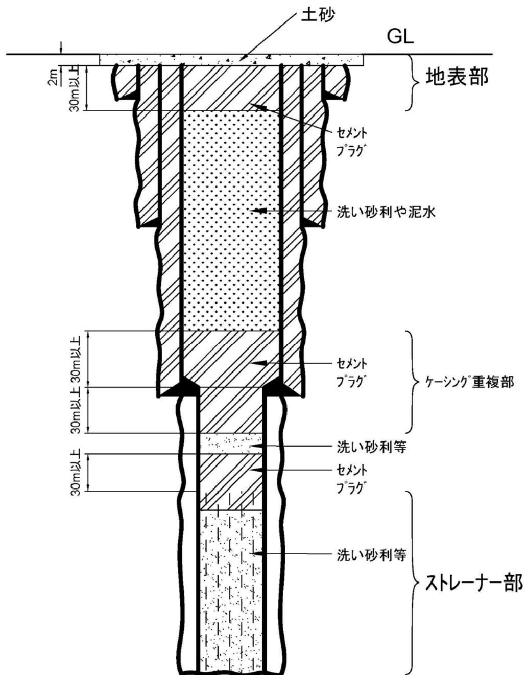
図 7 井戸埋戻しの概念図
