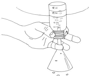
温泉付随ガスが容器内の温泉水を完全に置換し、容器からガスがあふれるのを確認したら静かに開口部を下にしたまま鉛直上方の空气中に引き上げ携帯形可燃性ガス検知器のプローブを迅速に下方から挿入し測定する。
