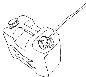
栓を外し、携帯形可燃性ガス検知器のプローブを迅速に容器に挿入するか、あらかじめ測定用のアタッチメントを取り付けた栓に検知器のプローブを接続し測定する。
