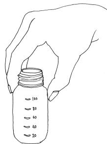
温泉付随ガスを湧出している温泉水中にポリビンを静かに転倒し開口部を温泉付随ガスの湧出する下方に向ける。
