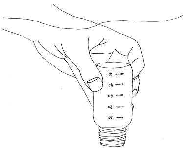
温泉付随ガスの湧出口にバケツを設置し、温泉水中で温泉付随ガスが湧出するようになるか、湧出口に空気混入がないようホースを設置しホースを温泉水で満たしたバケツ等の水面下に設置し、温泉付随ガスを容器に集めてよい。
