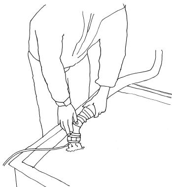
測定容器に温泉水と温泉付随ガスを導入する。容器に採取する量は、温泉水量で測定容器の実用量の 5 分の 1 とする。温泉水が容器の 5 分の 1 に達したら容器を速やかに密栓し、振とうする。
