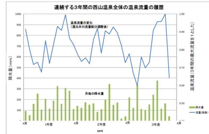
温泉モニタリングの結果(温泉流量と降水量の関係) 出典:「第5回地熱資源開発に係る温泉・地下水への影響検討会(平成23年11月)資料1」
