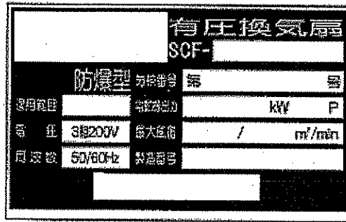
図 10 換気扇の銘板 (一例)
