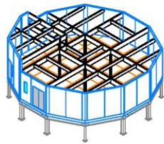
58 I期工事 1階小梁・内階段
