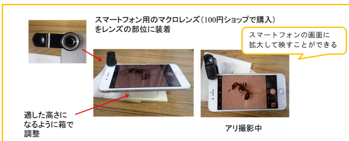
図 5-4 マクロレンズを取り付けたスマートフォンによる撮影
