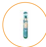
マイクロチップ 原寸大（直径2mm、長さ12mm）
