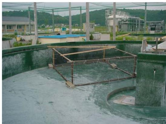
図 - 27 工事用ネットで作成した障害物 (栃木県水産試験場)
