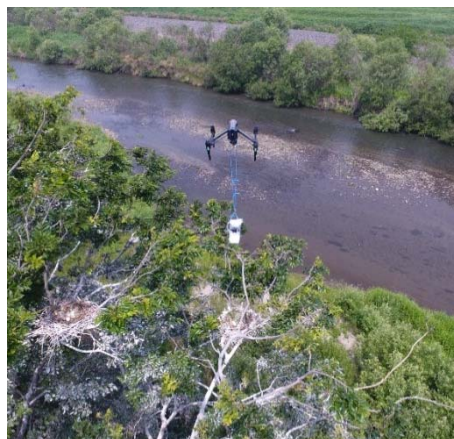
写真4. ドライアイスの投入（山梨県甲府市笛吹川河畔）。スイッチでボトルの底板が外れドライアイスが投入される仕組み。
