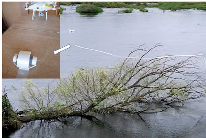
写真3. 鬼怒川漁業協同組合と共同で行ったビニルひも張り。トイレットペーパーの芯に生分解性のビニルひもを装着し、絡まないようにゴムひもで一定のテンションがかかるようになっている手作り感満載の装置。
