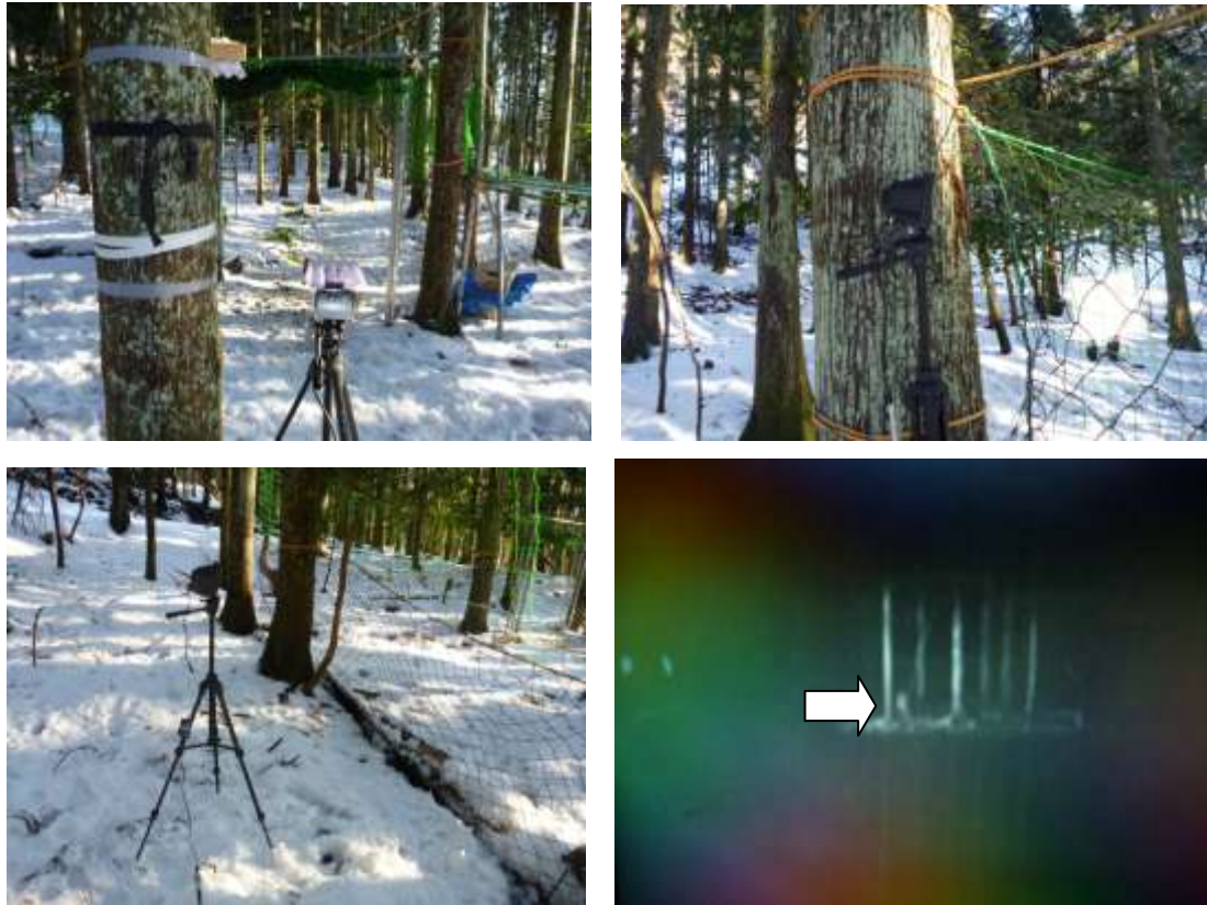
写真 3-4 モニターカメラ（左上）・赤外線投光器（右上・左下）および撮影された映像（右下）
