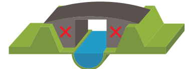
図 4) 障害物の撤去 可能であれば障害物を撤去もしくは改良して水の流れる場所を確保する。
