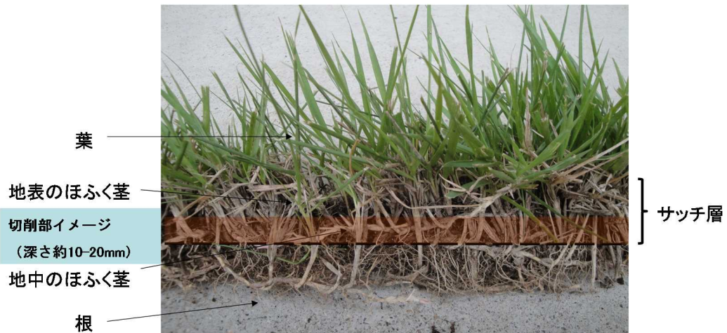
図 2-62 除染に相当する芝生と表土の切削部イメージ
