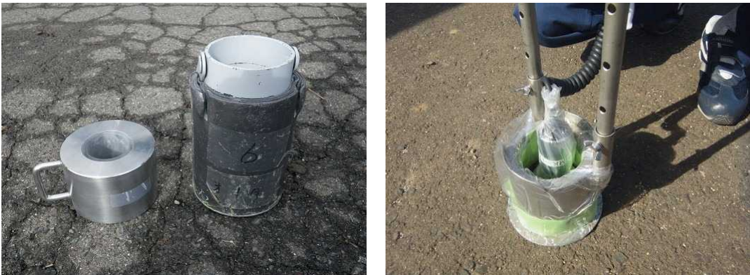
図1-12 コリメータの例（左）とコリメータを使用した表面線量率の測定の例（右）
