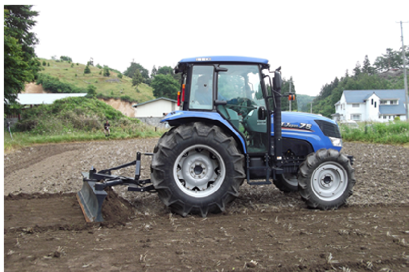
図 2-54 農機による農地の削り取りの例
