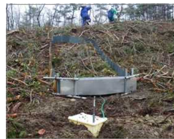
設置した試験斜面枠 (アカマツ・広葉樹混交林)
