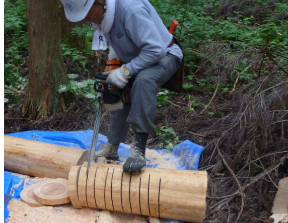
写真5 材の試料のサンプリング
