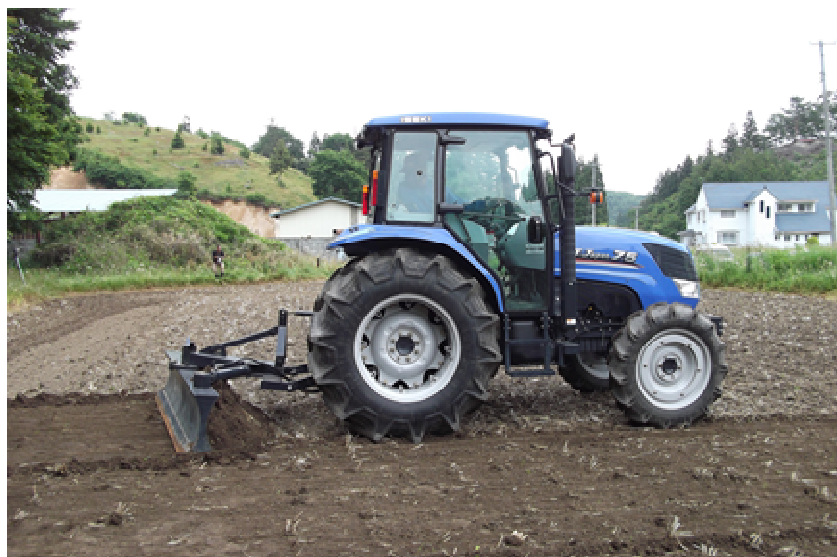
図 2-54 農機による農地の削り取りの例
