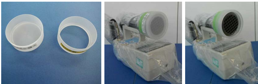
図1-19 プラスチック遮へい板とスペーサの例（左）と 遮へい板およびスペーサの装着状態（中、右）
