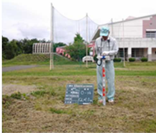
図 4 空間線量率の測定（例）
