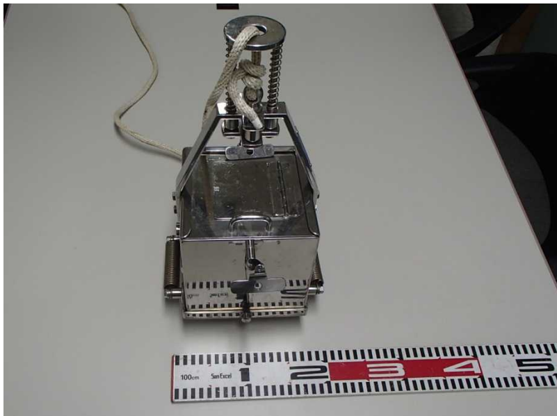
図1 エクマンバージ型採泥器
