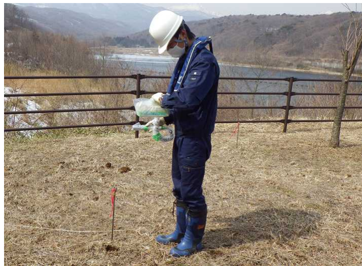
図4 空間線量率の測定(例)
